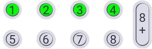
Der ersten Hubsäule, die gepaired wurde, ist die Nummer 1 zugeordnet, der zweiten die Nummer 2 usw.
