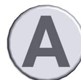
Blinkt bei einer Säule im Verbund die Taste <A>, kann der Verbund nicht gefahren werden. Normalerweise liegt dann eine Störung vor, oder mindestens eine Hubsäule befindet sich im Betriebsmodus SINGLE oder GROUP.
