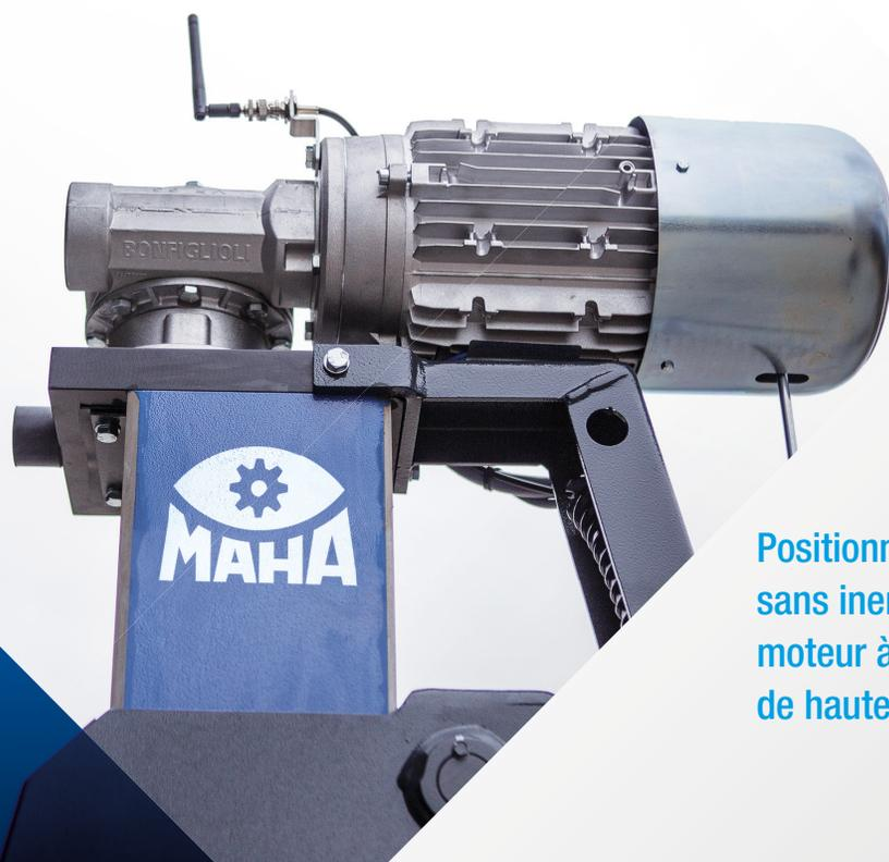
Positionnement en hauteur exact sans inertie du moteur grâce à un moteur à engrenage à vis sans fin de haute qualité
