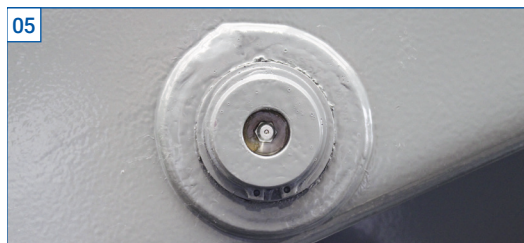
Scherenhauptlager mit Teflon-Gleitlagerbuchse und Schmiernippel, hohe Lebensdauer und Notlaufeigen- schaften.
