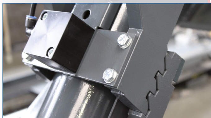
Die Rastenverzahnung wird bei Hebebühnen für die Fahrwerksvermessung (Option „Absetzvorrückung“) durch Fräsen gefertigt und sichert dadurch eine hohe Präzision auf unterschiedliche Arbeitshöhen.
