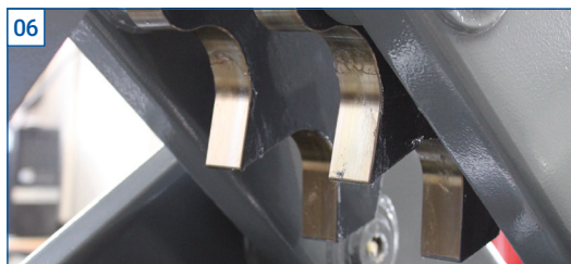
Die Zylinder-Aushubunterstützung mit Stufenhebel und Rollen führt eine reine Abrollbewegung aus. Keine Gleitbe- wegung zwischen den bewegten Teilen, dadurch geräusch- los, verschleiß- und wartungsarm.
