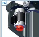
Dreifache Sicherheit durch Motorbremse. Kein Nachlaufen mehr möglich.
