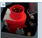
MA STAR = Plug & Play. Alle Versorgungsleitungen steckbar inkl. automatischer Drehfelderkennung (keine Elektrofachkraft notwendig).
