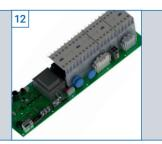
Sämtliche Sensoren und Optionen (zweite Bedieneinheit, Deckenlichtschranke) mit elektrischer Versorgung auf Platine steckbar (plug & play).
