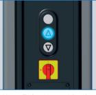
Untere Endposition erreicht oder auf Hindernis aufgefahren. Nur Heben möglich. Heben-Taste leuchtet blau.
