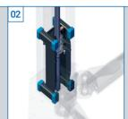
Optimale Lastverteilung durch im H-Profil schienengeführte, nahezu verschleißfreie Gleitsteine (8 Stück/Säule mit bis zu 24 Anlageflächen).
